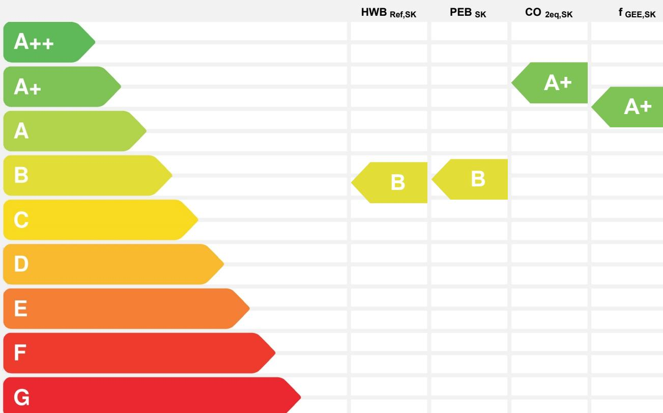
**HWB<sub>Ref</sub>**: Der **Referenz-Heizwärmeverbrauch** ist jene Wärmemenge, die in den Räumen bereitgestellt werden muss, um diese auf einer normativ geforderten Raumtemperatur, ohne Berücksichtigung allfälliger Erträge aus Wärmerückgewinnung, zu halten.
