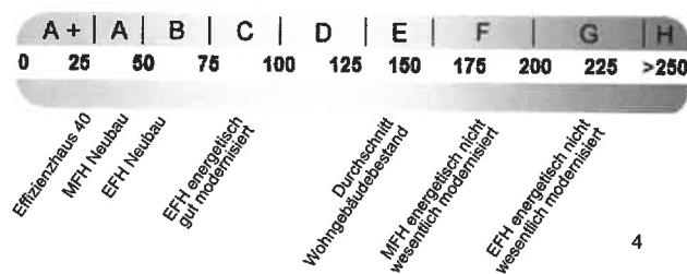
Die modellhaft ermittelten Vergleichswerte beziehen sich auf Gebäude, in denen die Wärme für Heizung und Warmwasser durch Heizkessel im Gebäude bereitgestellt wird. Soll ein Energieverbrauch eines mit Fern- oder Nahwärme beheizten Gebäudes verglichen werden, ist zu beachten, dass hier normalerweise ein um 15 bis 30 % geringerer Energieverbrauch als bei vergleichbaren Gebäuden mit Kesselheizung zu erwarten ist.
