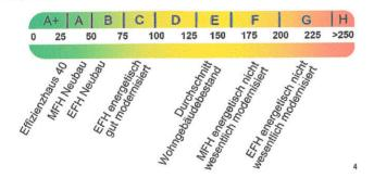
Die modellhaft ermittelten Vergleichswerte beziehen sich auf Gebäude, in denen Wärme für Heizung und Warmwasser durch Heizkessel im Gebäude bereitgestellt
