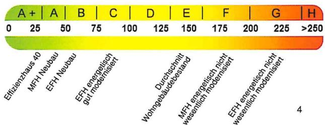
Die modellhaft ermittelten Vergleichswerte beziehen sich auf Gebäude, in denen die Wärme für Heizung und Warmwasser durch Heizkessel im Gebäude bereitgestellt wird.
