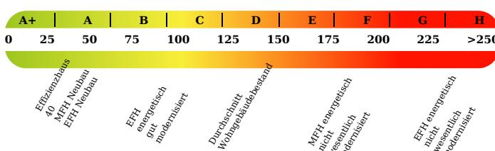
Die modellhaft ermittelten Vergleichswerte beziehen sich auf Gebäude, in denen Wärme für Heizung und Warmwasser durch Heizkessel im Gebäude bereitgestellt wird.
