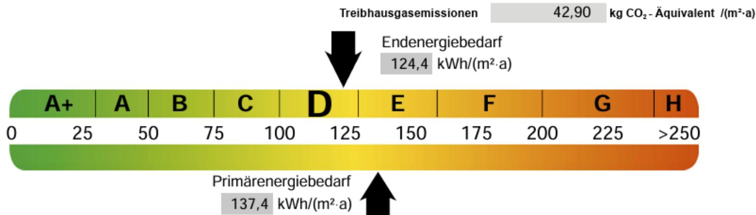
Anforderung gemäß GEG <sup>2</sup>PrimärenergiebedarfIst-Wert 137,38 kWh/(m<sup>2</sup>·a) Anforderungswert 105,35 kWh/(m<sup>2</sup>·a)Energetische Qualität der Gebäudehülle H<sub>T</sub>Ist-Wert 0,55 W/(m<sup>2</sup>·K) Anforderungswert 0,40 W/(m<sup>2</sup>·K)Für Energiebedarfsberechnungen verwendetes Verfahren
