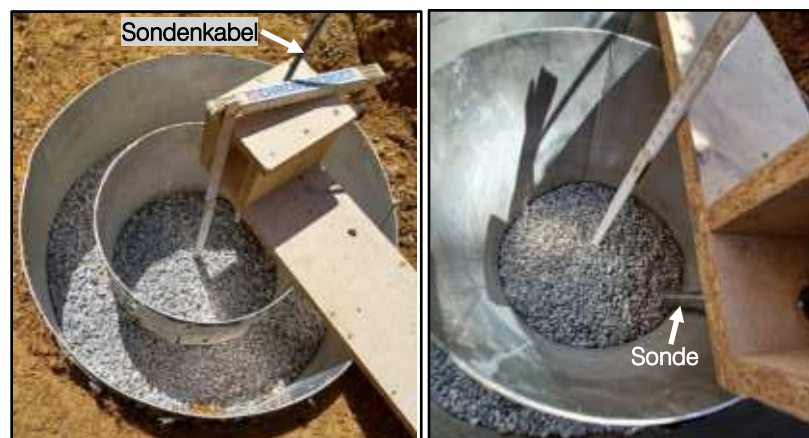
Abbildung 11: Versuchsaufbau mit Doppelringinfiltrometer, Druckmesssonde und Kiesschicht
