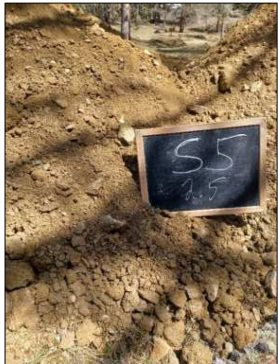
Abbildung 10: Bodenprofil und Aufnahmen von S5. Links: Sand/Kieslage mit hellem Granitgneis, z.T. verwittert/vergrust. Rechts: Sand-Kies, gering schluffig, gering steinig, sehr gering blockig.
