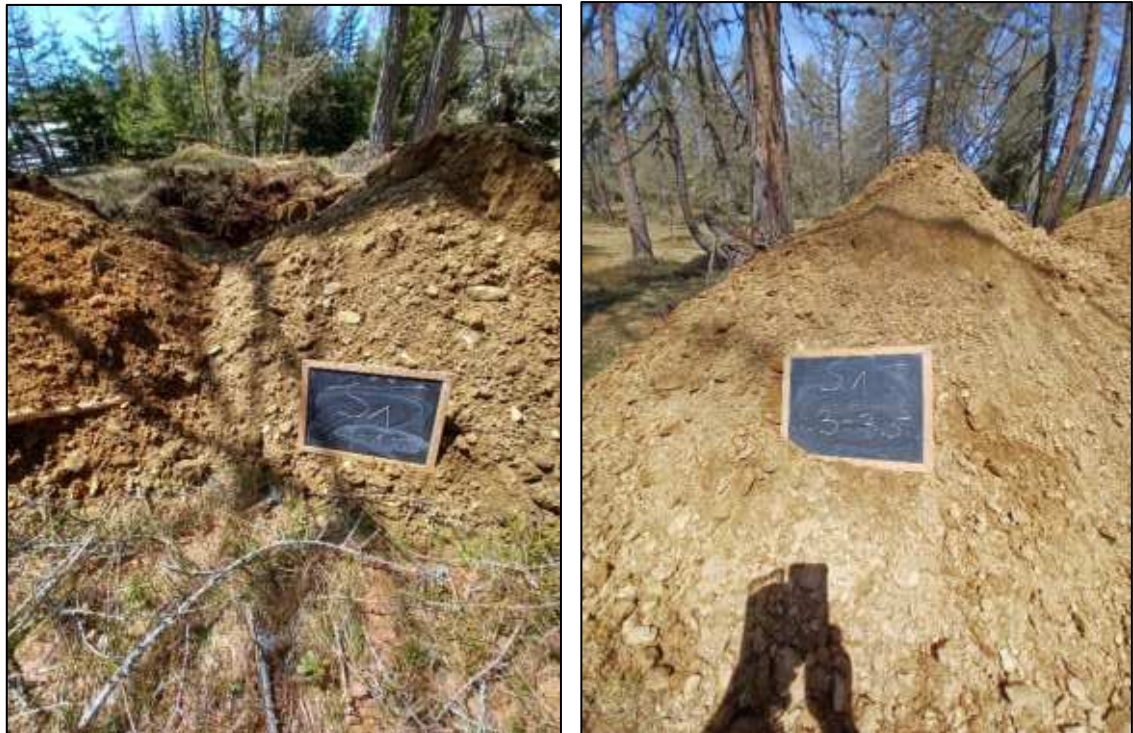
Abbildung 6: Bodenprofil und Aufnahmen von S1. Farbwechsel des Bodens bei ca. 1 m u.GOK.
