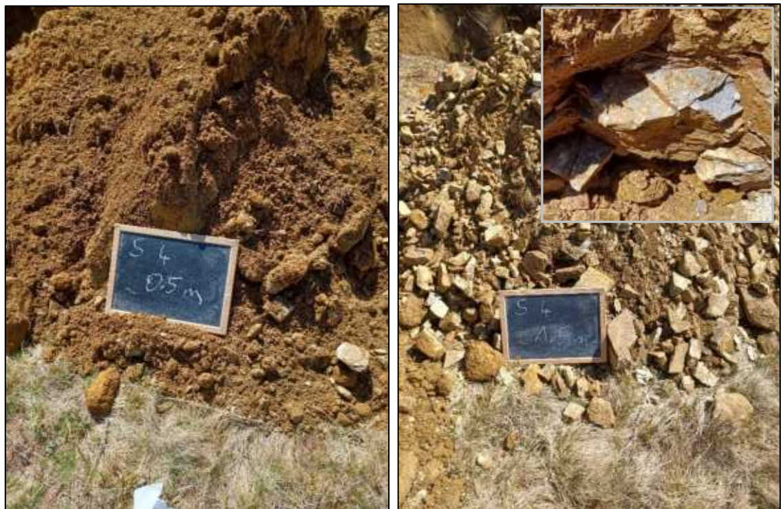
Abbildung 9: Bodenprofil und Aufnahmen von S4. Links: Sand-Kies, schluffig, gering tonig, sehr gering steinig, sehr gering blockig. Rechts: Anstehender Schiefer/Phyllit mit sandig-kiesiger Kluftfüllung.
