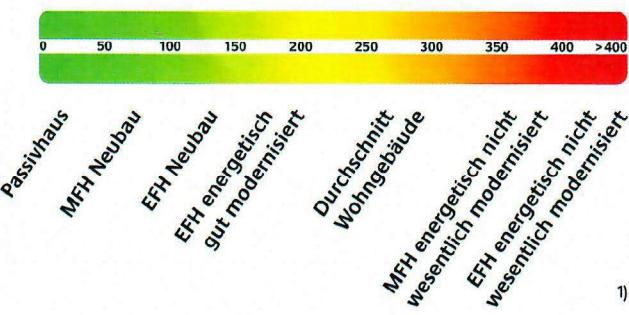
Die modellhaft ermittelten Vergleichswerte beziehen sich auf Gebäude, in denen die Wärme für Heizung und Warmwasser durch Heizkessel im Gebäude bereitgestellt wird.
