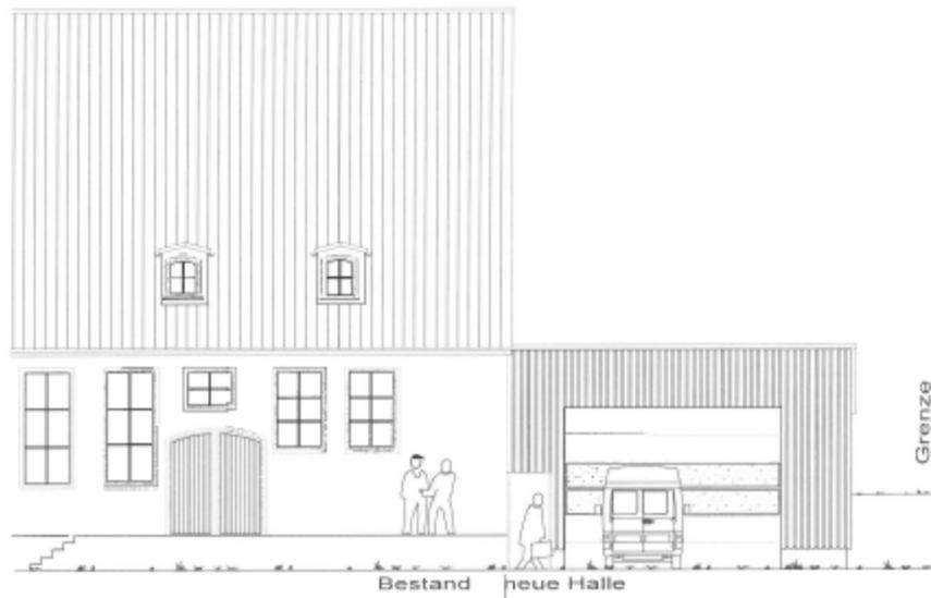
**Gebäude:** Das Hauptgebäude wurde in Massivbauweise und die Anbauten wurden in Stahl und Sandwich errichtet.
