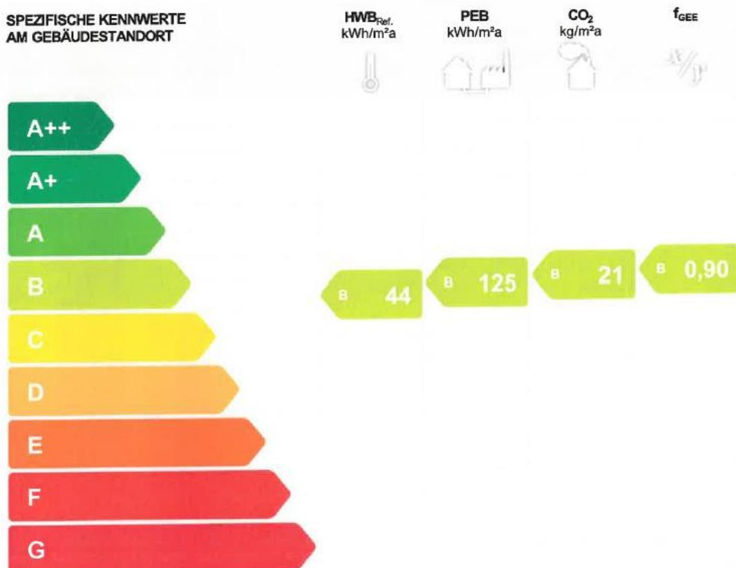
**HWB<sub>Ref.</sub>:** Der Referenz-Heizwärmebedarf beschreibt jene Wärmemenge, die in einem Raum bereitgestellt werden muss, um diesen auf einer normativ geforderten Raumtemperatur (bei Wohngebäude 20°C) halten zu können. Dabei werden etwaige Erträge aus Wärmerückgewinnung bei vorhandener raumluftechnischer Anlage nicht berücksichtigt.
