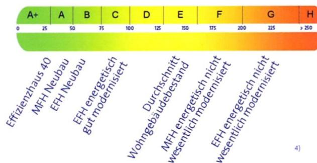
Die modellhaft ermittelten Vergleichswerte beziehen sich auf Gebäude, in denen die Wärme für Heizung und Warmwasser durch Heizkessel im Gebäude bereitgestellt wird.
