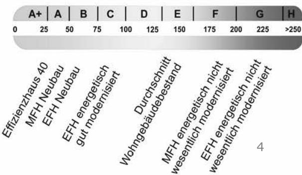
Die modellhaft ermittelten Vergleichswerte beziehen sich auf Gebäude, in denen die Wärme für Heizung und Warmwasser durch Heizkessel im Gebäude bereitgestellt wird. Soll ein Energieverbrauch eines mit Fern- oder Nahwärme beheizten Gebäudes verglichen werden, ist zu beachten, dass hier normalerweise ein um 15 bis 30 % geringerer Energieverbrauch als bei vergleichbaren Gebäuden mit Kesselheizung zu erwarten ist.
