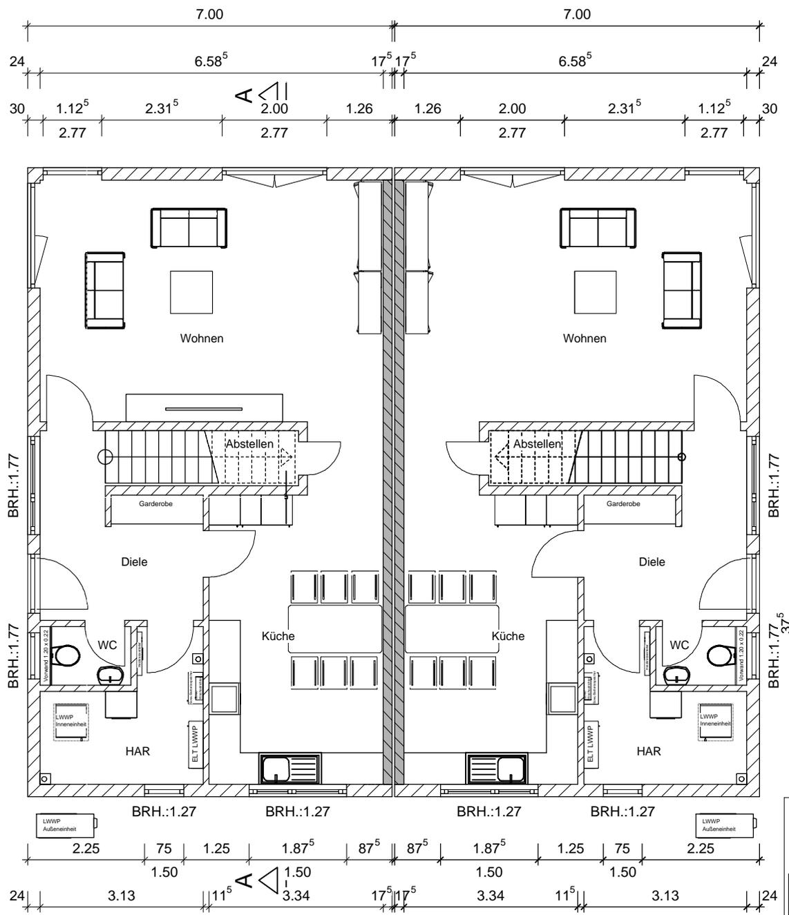
Um einen reibungslosen Einbau der Treppe zu ermöglichen, ist ein genügend großes Fenster gegenüber der Treppe im Erdgeschoss zwingend erforderlich. Bei einer Anpassung der Standardplanung muss die Ausführbarkeit geprüft werden.
