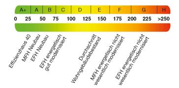
Die modellhaft ermittelten Vergleichswerte beziehen sich auf Gebäude, in denen die Wärme für Heizung und Warmwasser durch Heizkessel im Gebäude bereitgestellt
