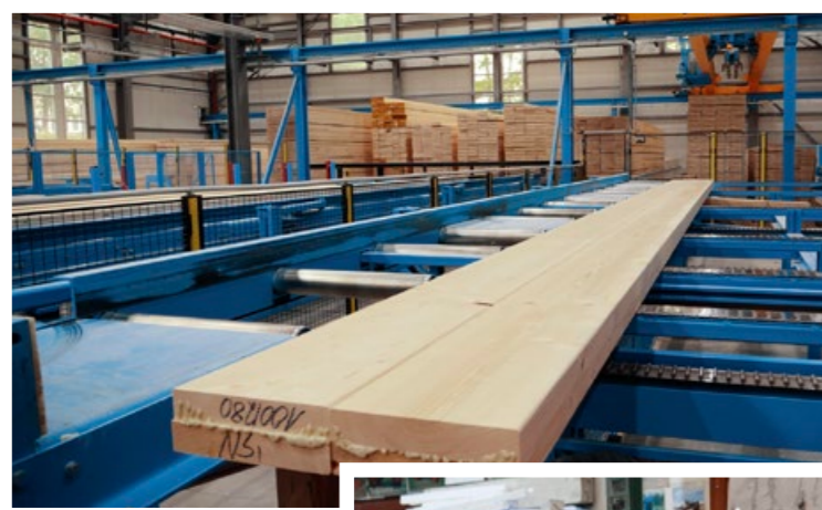
In unserem Werk in Simmern wird die komplette Holzhaushülle gefertigt und die Wände werden vormontiert.
