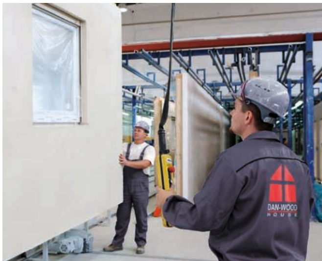
Die Wände werden in der Fabrik vorgefertigt...
