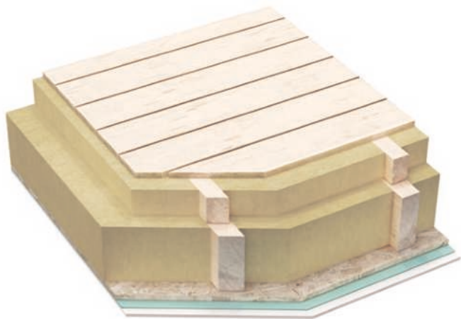
Aufbau der Kahlbalkendecke zum unbeheizten Spitzboden
