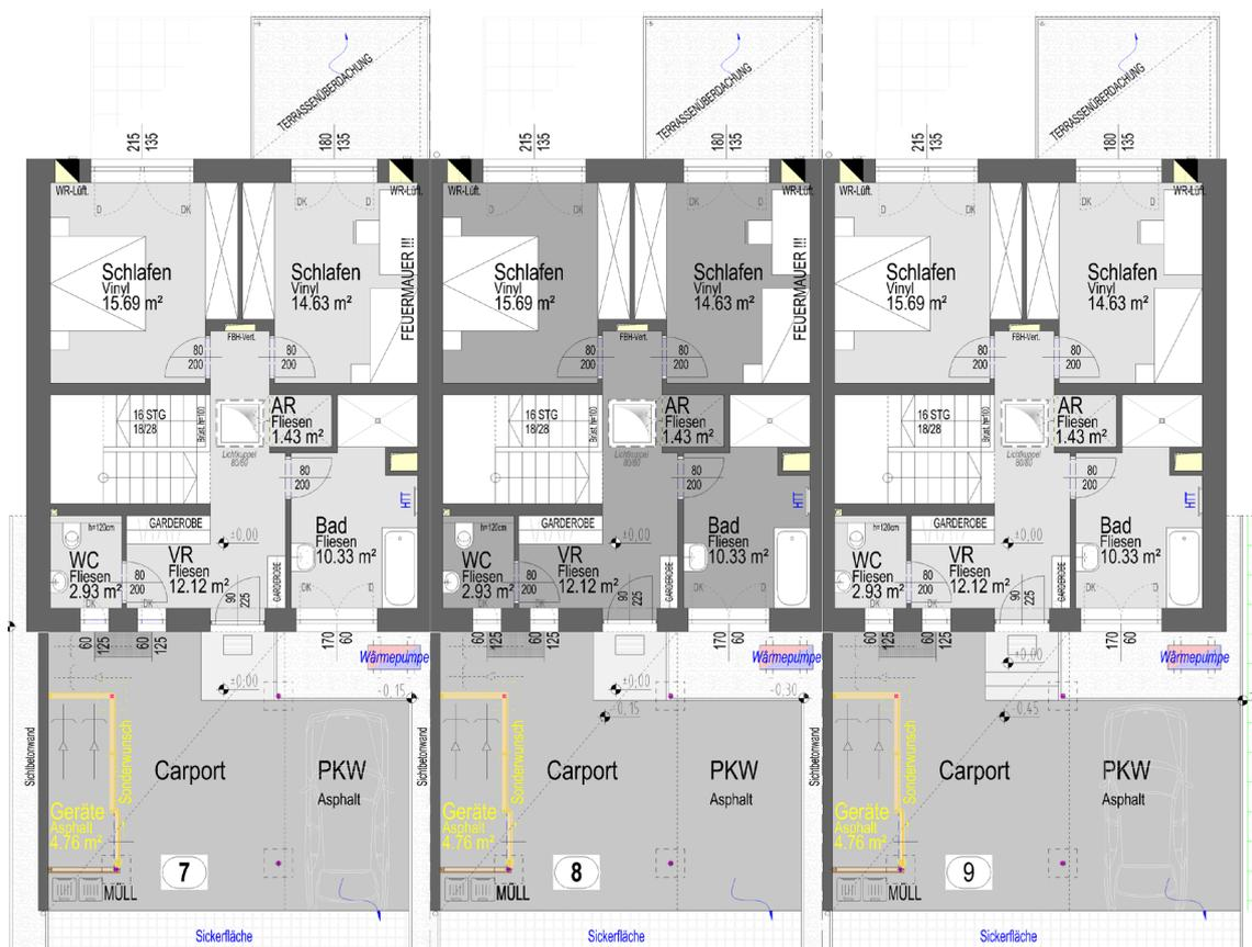
Grundriss Erdgeschoss RH 7-9
