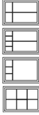
Bei Häusern der Hausserie „EH 40“ oder „EH 40 PV“ sind Sprossenfenster nur möglich, wenn zusätzliche energiesparende Maßnahmen getroffen werden. Sprossen verschlechtern den Dämmwert der Verglasung, daher können bei Sprossenfenstern zusätzliche, aufpreispflichtige energiesparende Maßnahmen erforderlich werden, um die Anforderungen an ein Effizienzhaus 40 gemäß GEG zu erfüllen.
