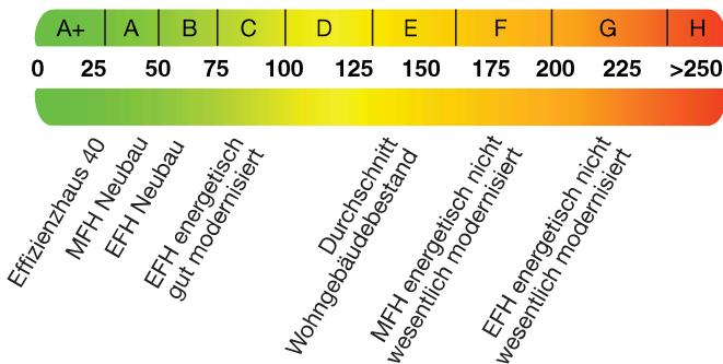
Die modellhaft ermittelten Vergleichswerte beziehen sich auf Gebäude, in denen die Wärme für Heizung und Warmwasser durch Hezkessel im Gebäude bereitgestellt wird.
