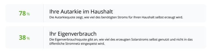
Die in dieser Simulation berechneten Ertragswerte basieren auf dem spezifischen Standort, der Neigung und der Ausrichtung der PV-Module. Sie stellen eine näherungsweise Schätzung dar und können im Individualfall abweichen. Die Ergebnisse sind nicht als verbindliche Zusage für die tatsächliche Leistung der Anlage zu verstehen.
