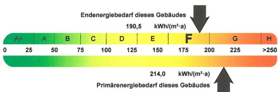
**Endenergiebedarf dieses Gebäudes**190,5 kWh/(m<sup>2</sup>·a)**Vergleichswerte Endenergie**
