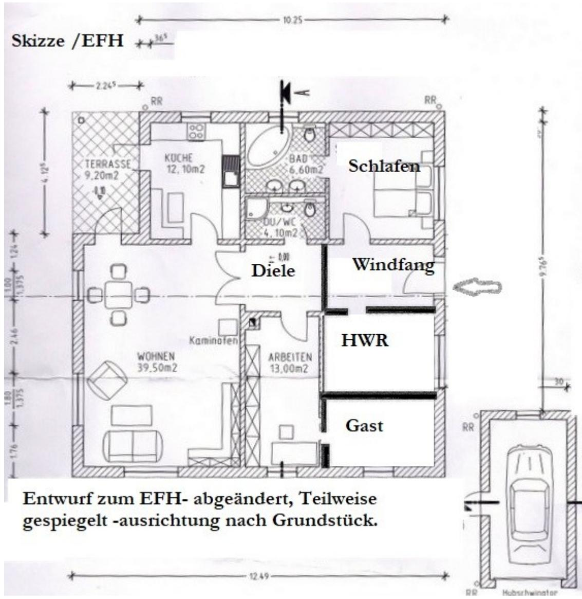
Entwurf zum EFH- abgeändert, Teilweise gespiegelt -ausrichtung nach Grundstück.
