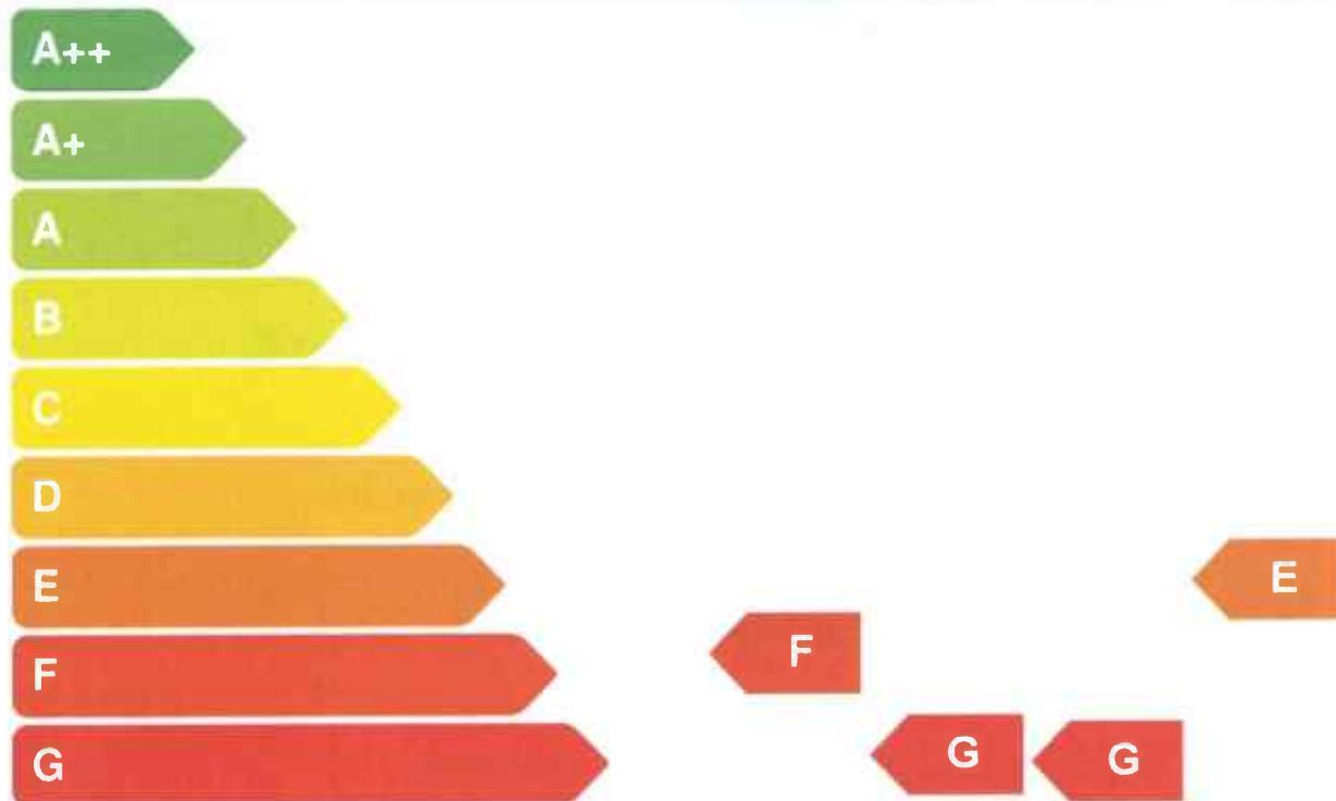
**HWB<sub>Ref</sub>**: Der **Referenz-Heizwärmebedarf** ist jene Wämmemenge, die in den Räumen bereitgestellt werden muss, um diese auf einer normativ geforderten Raumtemperatur, ohne Berücksichtigung allfälliger Erträge aus Wärmerückgewinnung, zu halten.
