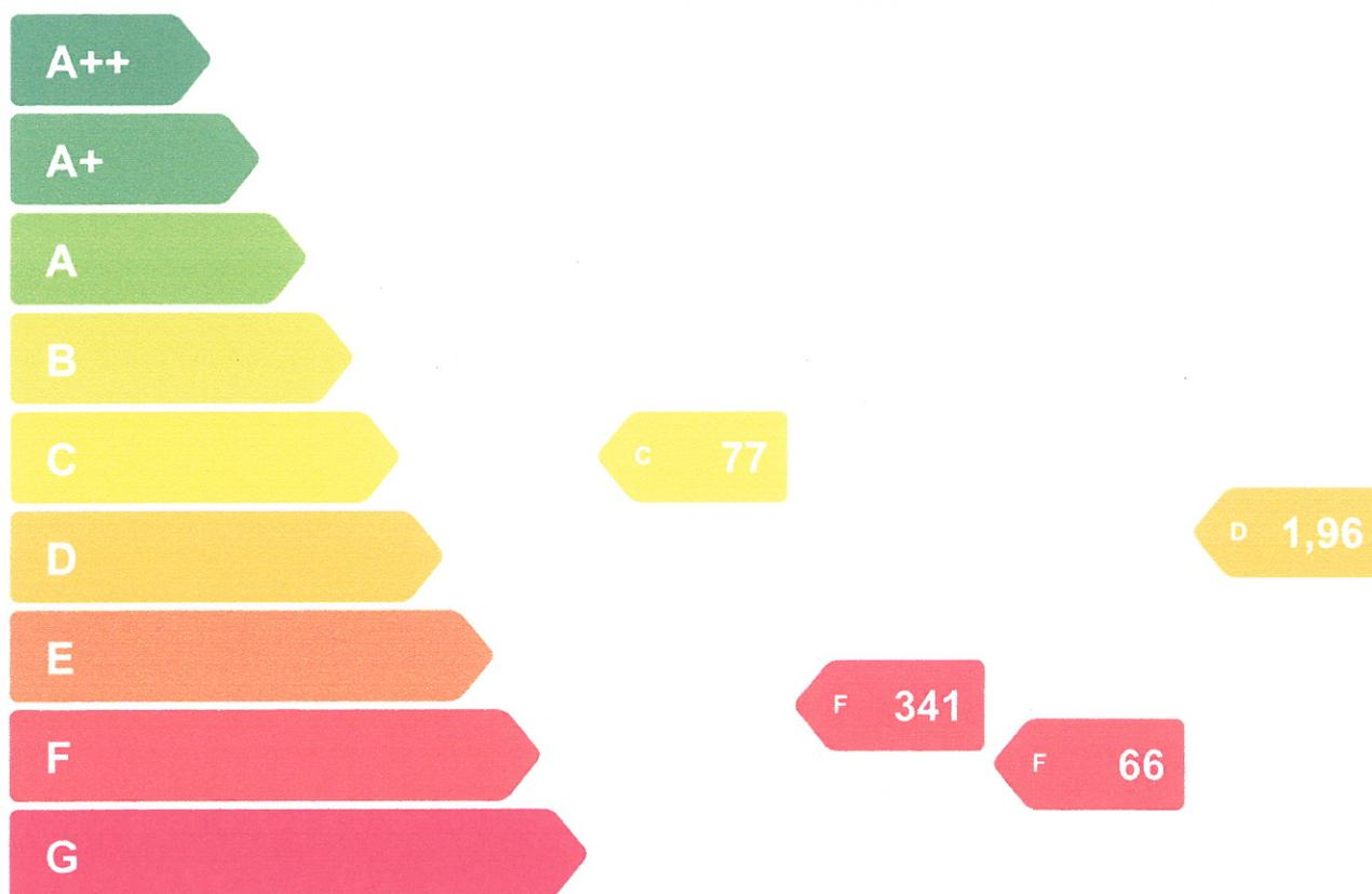
**HWB:** Der **Heizwärmebedarf** beschreibt jene Wärmemenge, die in einem Raum bereitgestellt werden muss, um diesen auf einer normativ geforderten Raumtemperatur (bei Wohngebäude 20°C) halten zu können.
