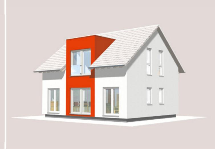
Abb.: Fassadengleiches Zwerchhaus mit Flachdach
