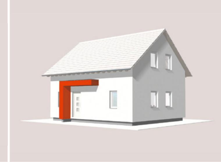
Abb.: Eingangsüberdachung mit Flachdach und einer Wandscheibe
