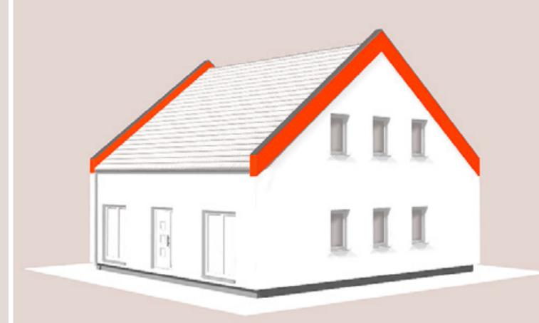
Abb.: Haus mit erhöhter Giebelwand
