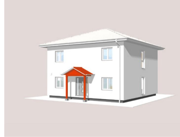
Abb.: Eingangsdach mit Giebel und verzinkten Stahlstützen
