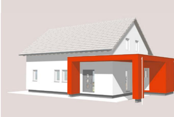
Abb.: Einzelcarport mit Hauseingangsüberdachung und Abstellraum
