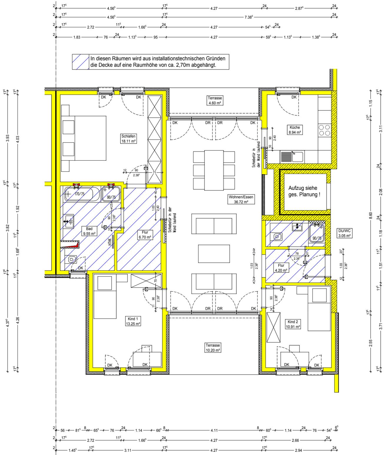
In diesen Räumen wird aus installationstechnischen Gründen die Decke auf eine Raumhöhe von ca. 2,70m abgehängt.
