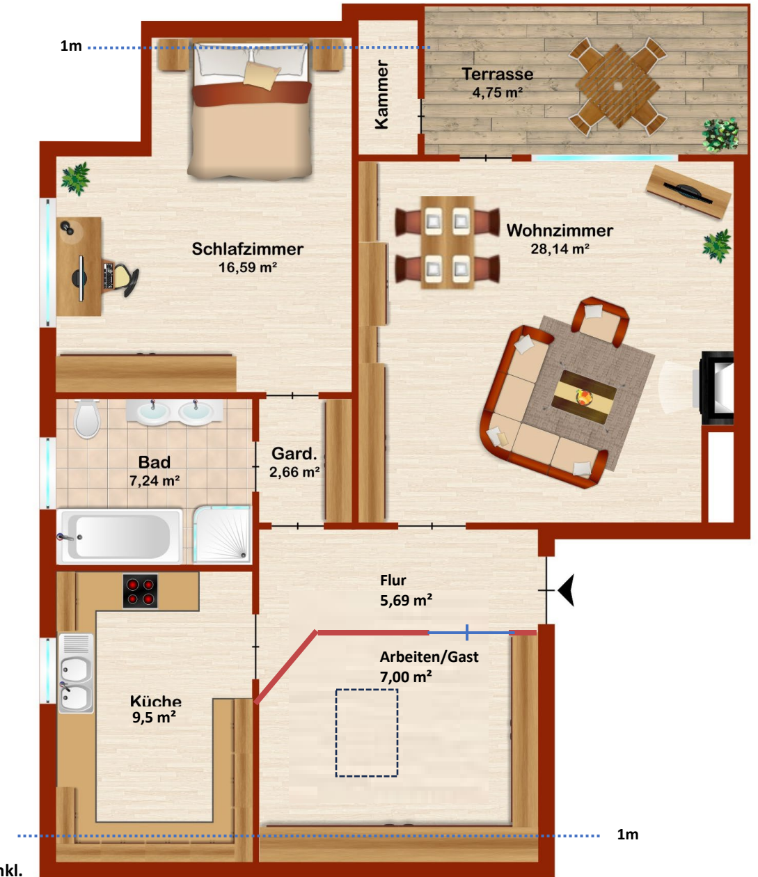
Aktueller Grundriss inkl. Trockenbauwand (Flur, Arbeiten/Gast)
