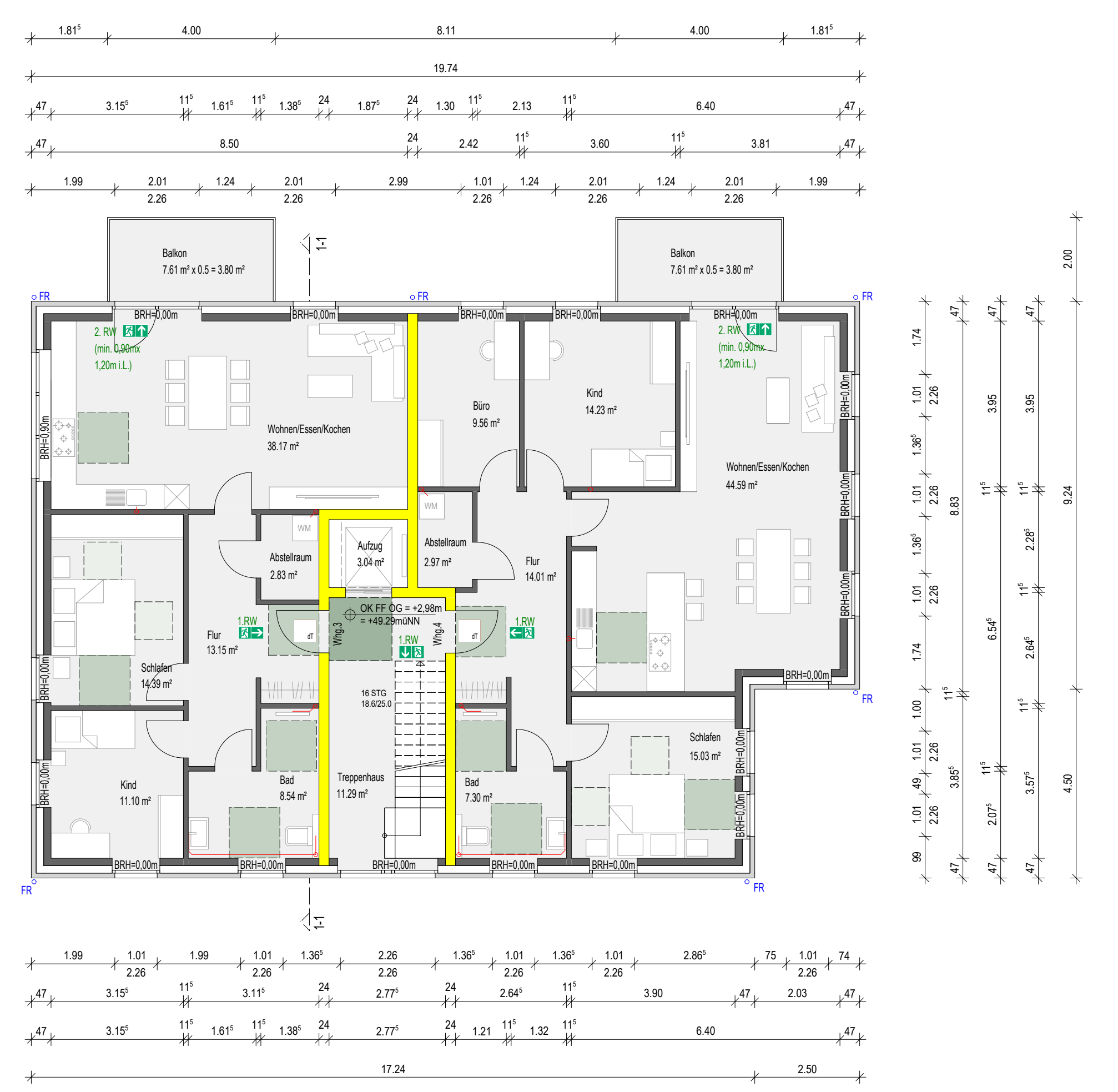
GRUNDRISS OBERGESCHOSS Rauchmeter nach BauORV §45
