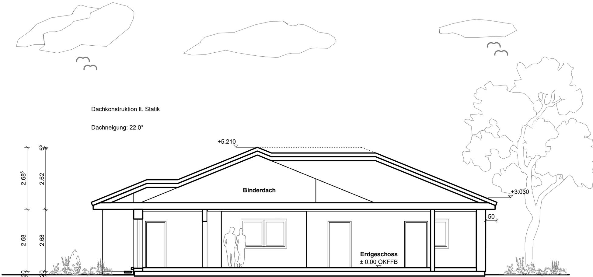
Dachkonstruktion lt. Statik
