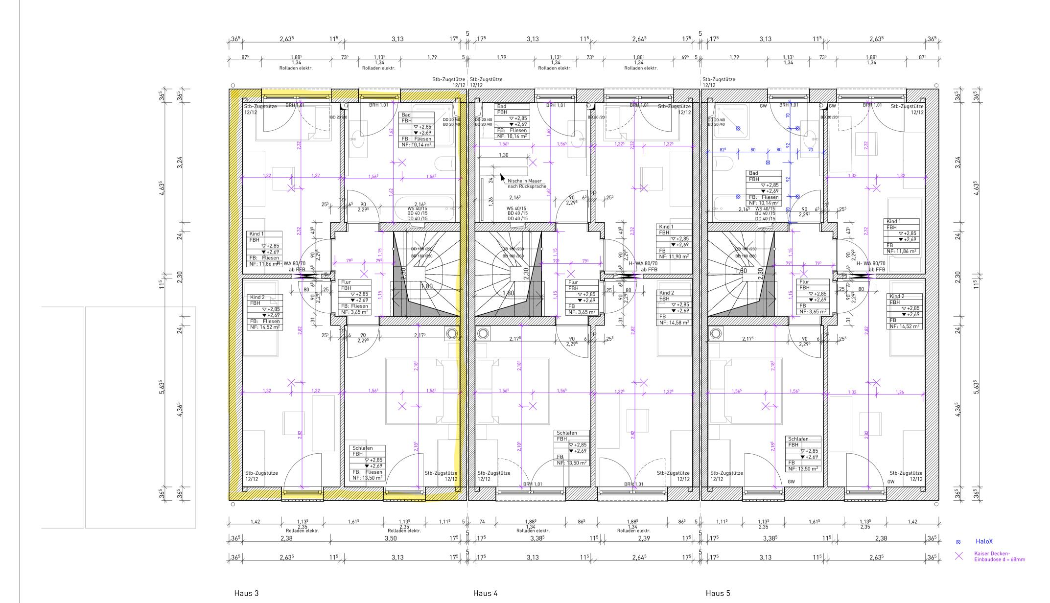
Baustoffe Stahlbeton C25/30 - C25/30 WU Außenmauerwerk (36,5 bzw. 42,5 cm) HLZ-Plan MZ 80-G Tragwände Innen : Planziegel HLZ 20/1,2 Wohnungstrennwände, Treppenhauswände Plan-Schalungszeigel Verfüllziegel 1,8-2,0 mit Beton Legende Unterzug
