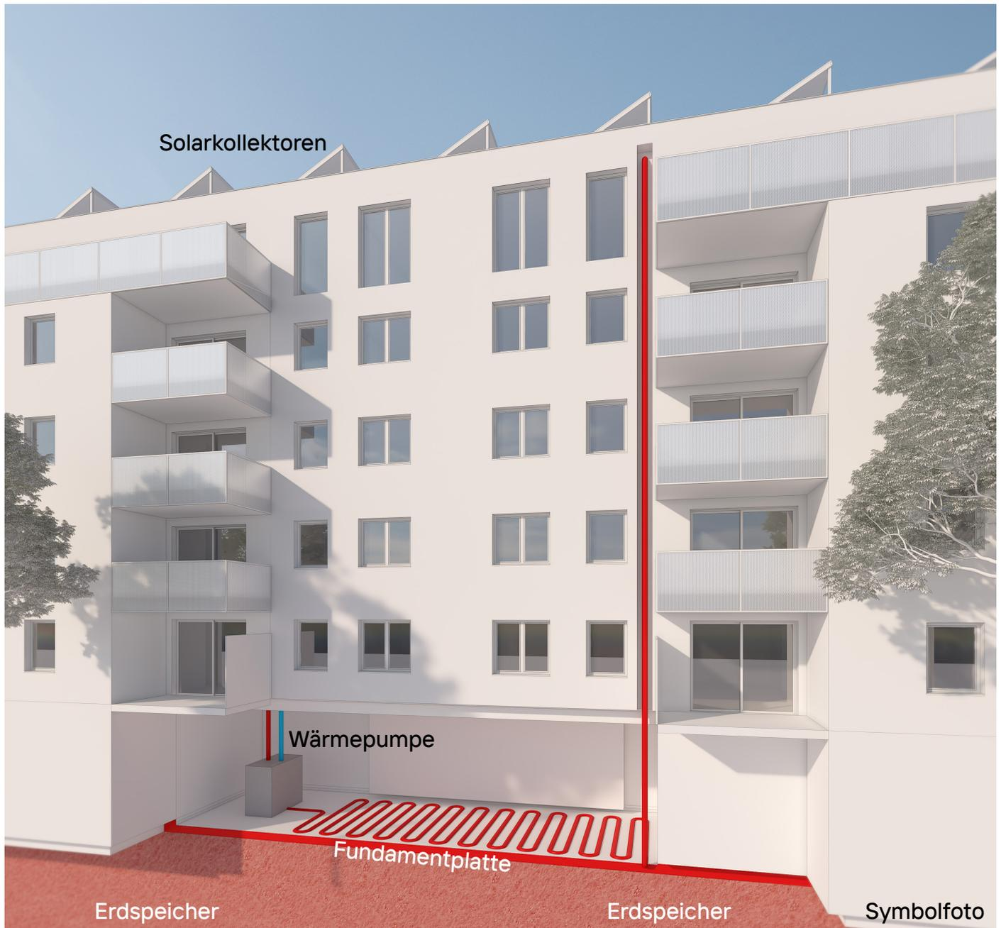
Die Solarkollektoren nutzen neben der direkten Sonnenstrahlung auch den diffusen Anteil der Sonne. Um die gesamte vom Kollektor bereitgestellte Sonnenenergie möglichst vollständig zu speichern und zeitversetzt für die Beheizung nutzen zu können, wird die Fundamentplatte und das sich unter dem Gebäude befindliche Erdreich als Speicher für Überschussenergie in der „warmen“ Jahreszeit genutzt.
