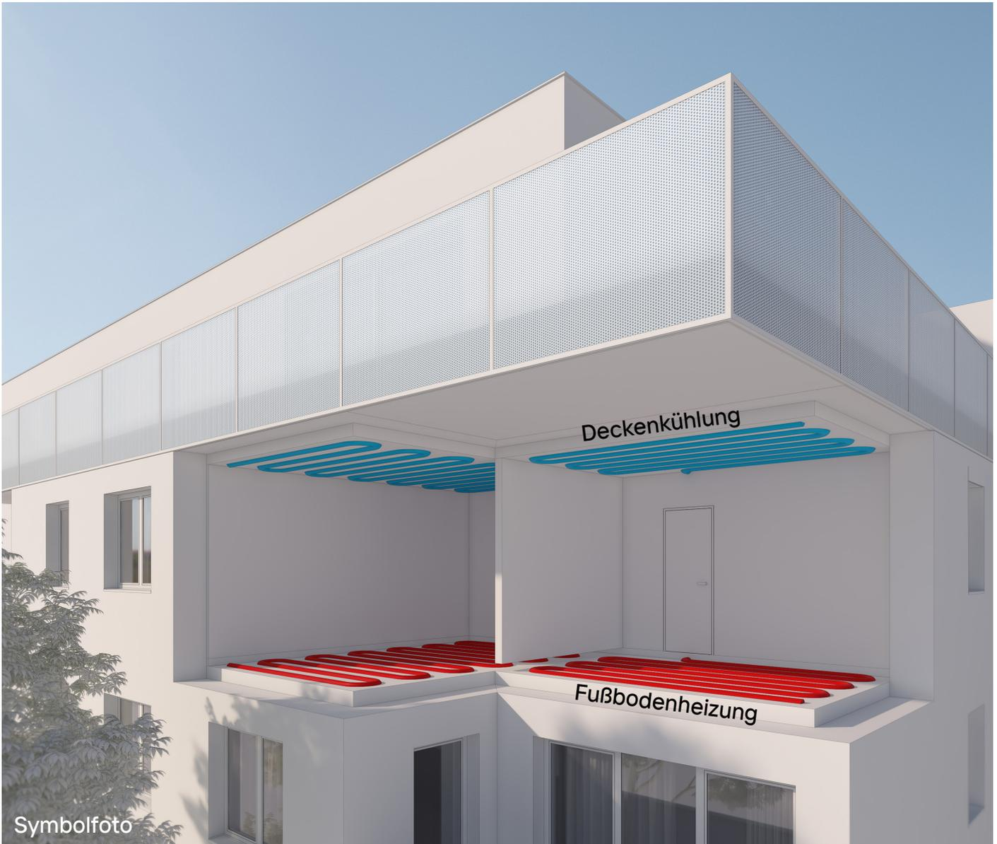
Beheizt werden die Wohnungen über eine energieeffiziente Fußbodenheizung. Die Deckenkühlung in den Aufenthaltsräumen (Wohnzimmer, Schlafzimmer, Zimmer) wird durch Kühlleitungen in der Betondecke gewährleistet. Dadurch entsteht im Sommer ein angenehm gleichmäßig temperiertes Raumklima (keine Klimaanlage). Die Heizungs- / Kühlungssteuerung wird über ein zentrales Thermostat im Wohnzimmer gesteuert.
