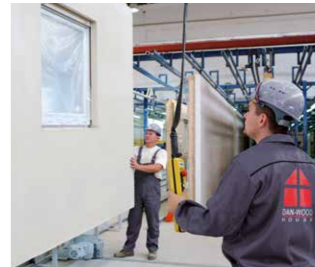
Die Wände werden in der Fabrik vorgefertigt...
