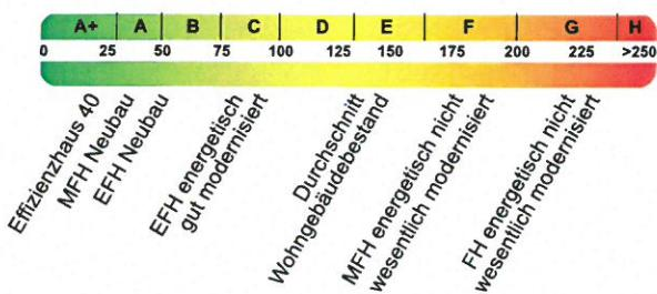
Die modellhaft ermittelten Vergleichswerte beziehen sich auf Gebäude, in denen die Wärme für Heizung und Warmwasser durch Heizkessel im Gebäude bereitgestellt wird.
