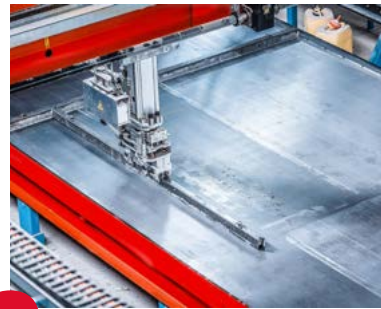
2 Einlegen der Schalung
