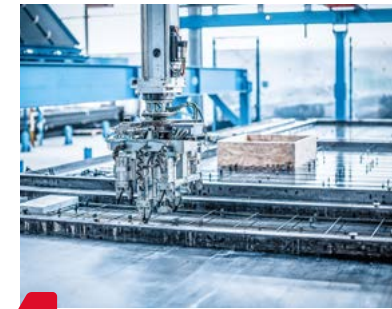
4 Einlegen der Bewehrung
