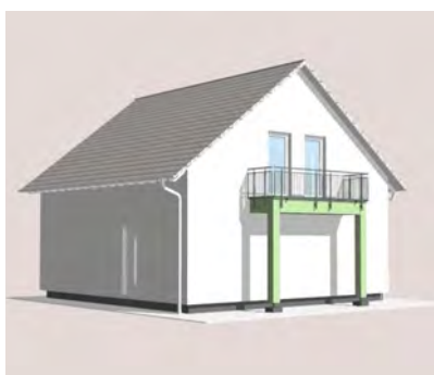
Holzbalkon vorgeständert verputzt
