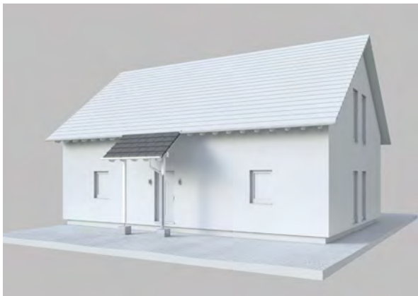
Dachabschleppung mit Stützen
