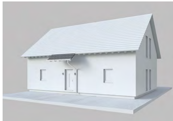
Dachabschleppung ohne Stützen
