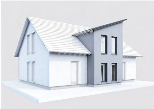
Zwerchgiebel vorgezogen mit Pulldach (Darstellung mit (farbigem) Putz)
