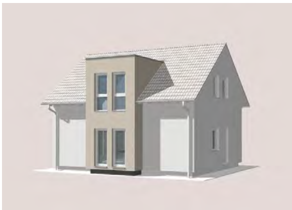
Zwerchgiebel vorgezogen mit Flachdach (Darstellung mit (farbigem) Putz)
