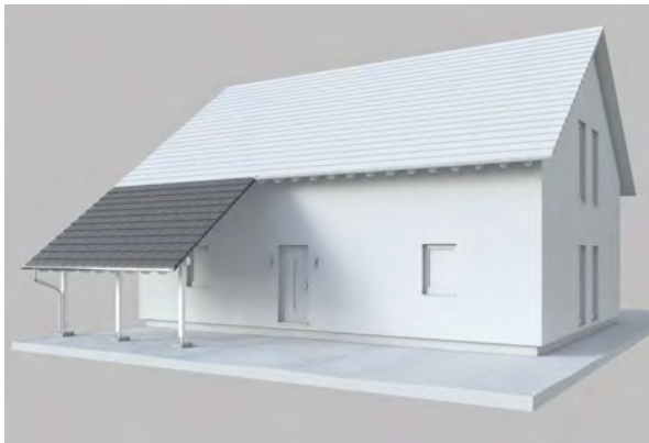
Carport mit Dachabschleppung
