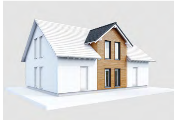
Zwerchgiebel wandbündig mit Satteldach (Darstellung mit Holzverschalung)
