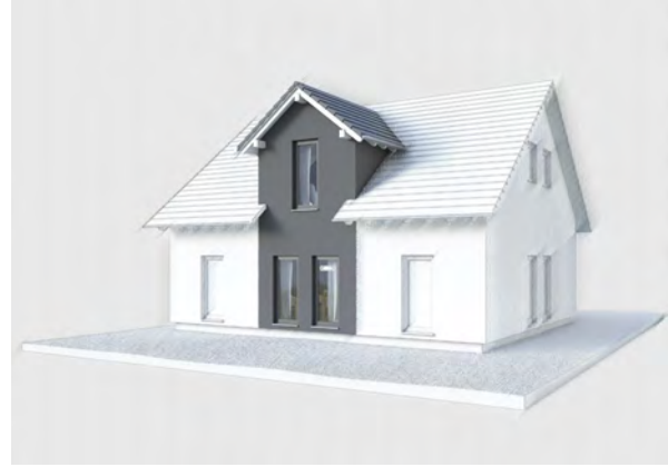
Zwerchgiebel mit Satteldach (Darstellung mit (farbigem) Putz)
