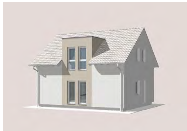
Zwerchgiebel wandbündig mit Flachdach (Darstellung mit (farbigem) Putz)
