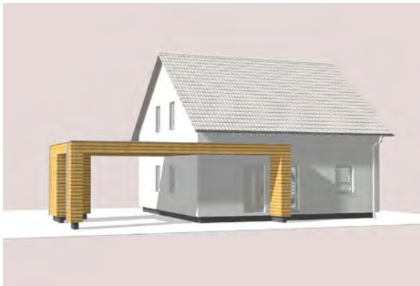
Carport mit Hauseingangsüberdachung (Darstellung mit Holzverschalung)
