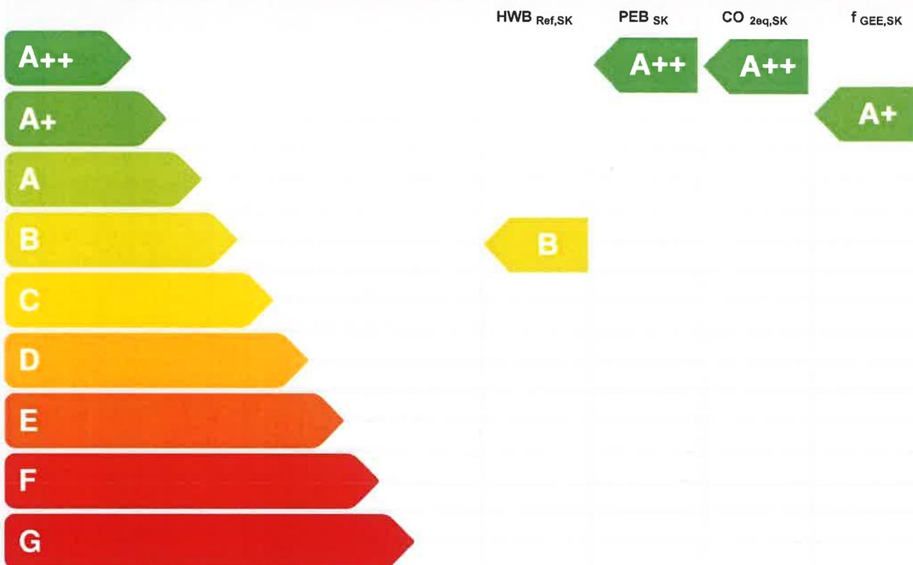
**HWB<sub>Ref,SK</sub>:** Der Referenz-Heizwärmebedarf ist jene Wärmemenge, die in den Räumen bereitgestellt werden muss, um diese auf einer normativ geforderten Raumtemperatur, ohne Berücksichtigung allfälliger Erträge aus Wärmerückgewinnung, zu halten.
