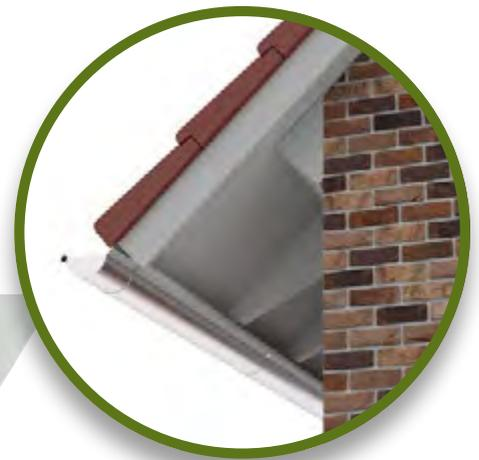
1. Sparren, 240 mm, gehobelt, im Sichtbereich mit deckendem Anstrich, Sparrenkopf mit Schrägschnitt
