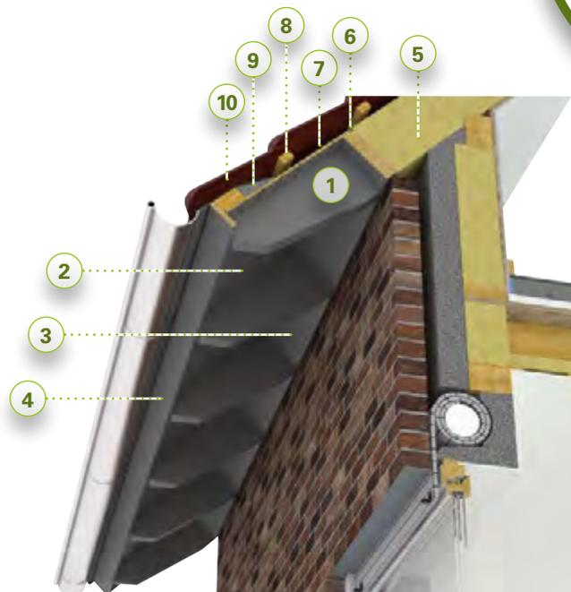
1. Sparren, 240 mm, gehobelt, im Sichtbereich mit deckendem Anstrich, Sparrenkopf mit Abschrägung
