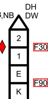
Kennzeichnung der Brandwiderstandsklasse der Decken und Bedachungen, z.B.: Kennzeichnung eines dreigeschossigen Gebäudes:
