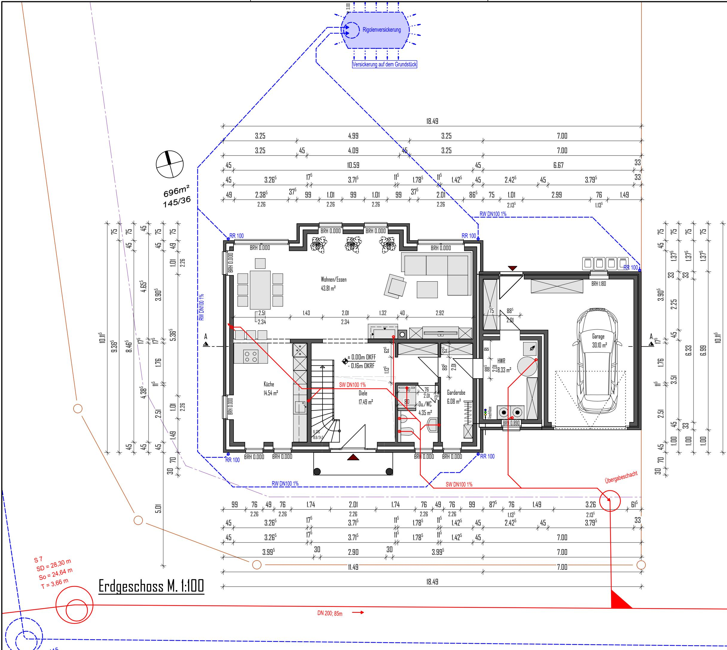
Alle Maße beziehen sich, soweit nichts anderes angegeben, auf den Rohbau. Maßangaben für Fensterbrüstungen, Fenster- und Türschlitze beziehen sich grundsätzlich auf die Oberkante Fertigfußboden.
