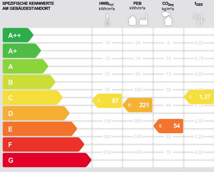
**HWB<sub>Ref.</sub>:** Der Referenz-Heizwärmebedarf ist jene Wärmemenge, die in den Räumen bereitgestellt werden muss, um diese auf einer normativ geforderten Raumtemperatur zu halten. Dabei werden etwaige Erträge aus Wärmerückgewinnung raumluftechnischer Anlage nicht berücksichtigt.
