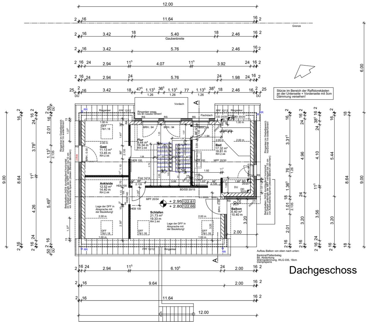
Stürze im Bereich der Raffstorenkästen an der Unterseite + Vorderseite mit 5cm Dämmung versehen!
