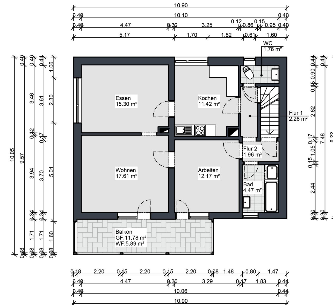
Die Ermittlung der Flächen erfolgte aufgrund einer CAD-Zeichnung nach WoFIV (BGBI. S. 2346).
