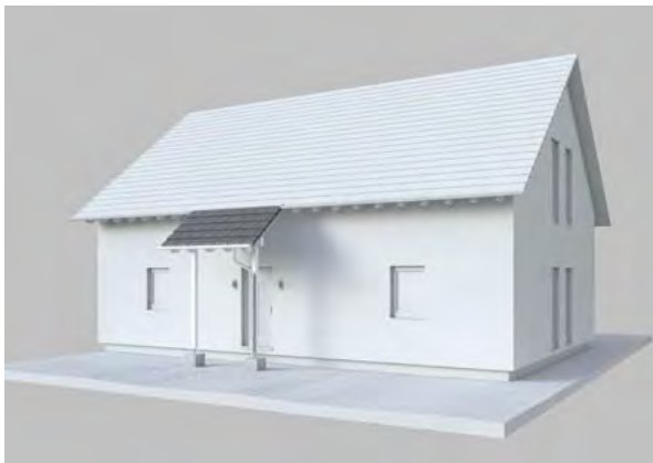
Dachabschleppung mit Stützen
