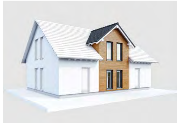
Zwerchgiebel wandbündig mit Satteldach (Darstellung mit Holzverschalung)
