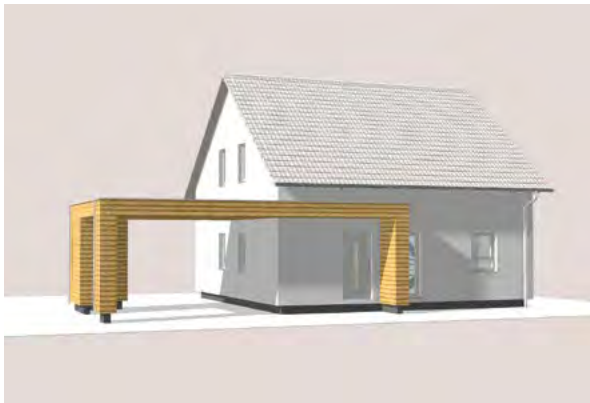
Carport mit Hauseingangsüberdachung (Darstellung mit Holzverschalung)
