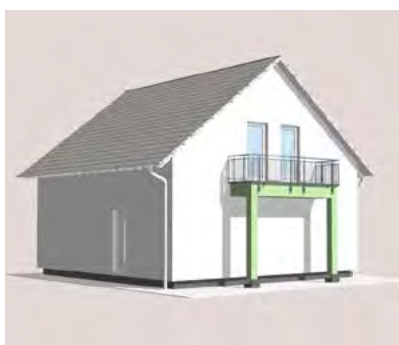
Holzbalkon vorgeständert verputzt
