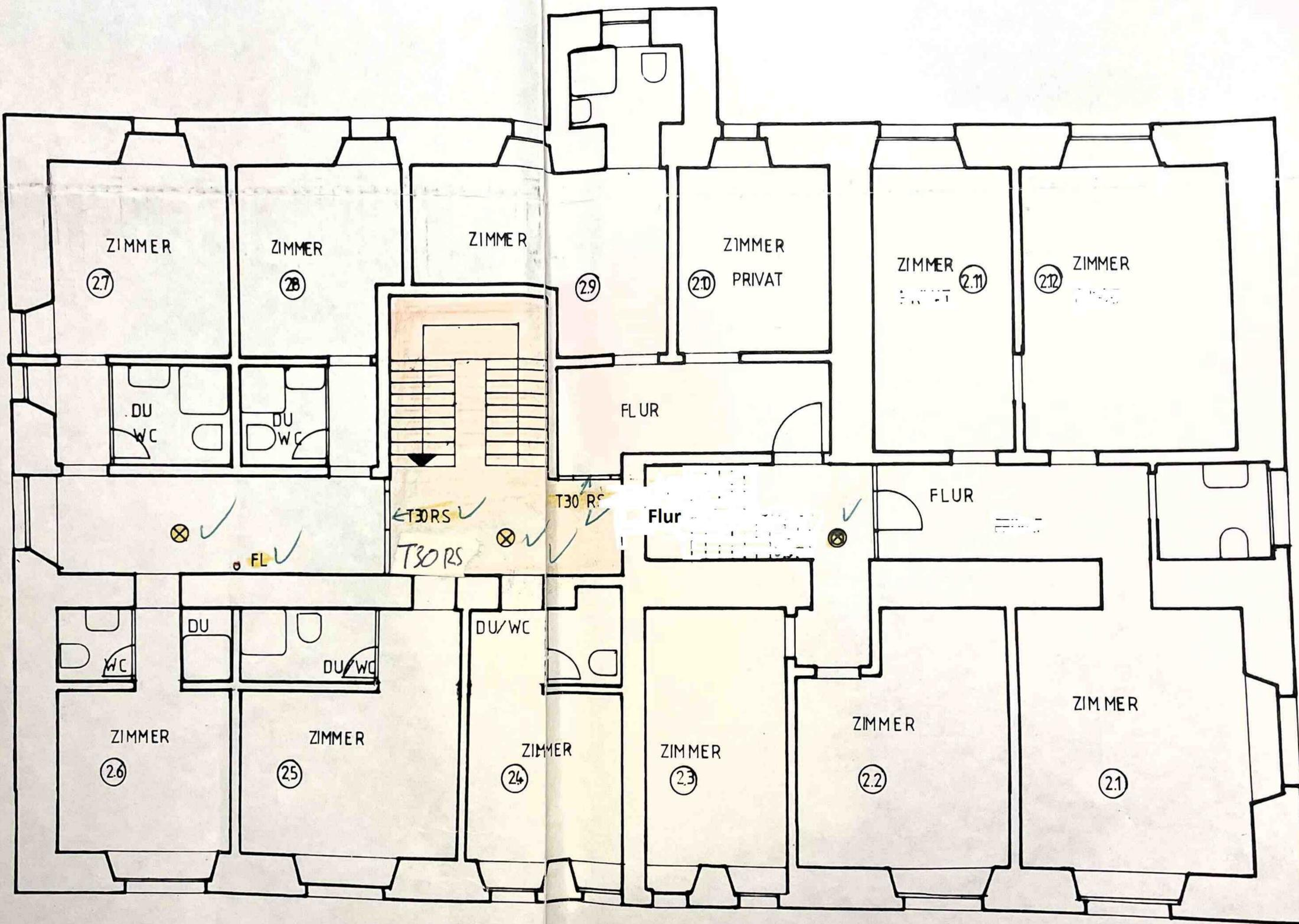
T 30 TÜREN RAUCHSICHER - DOPPELFALZ OD. EINFACH DICHTUNG
