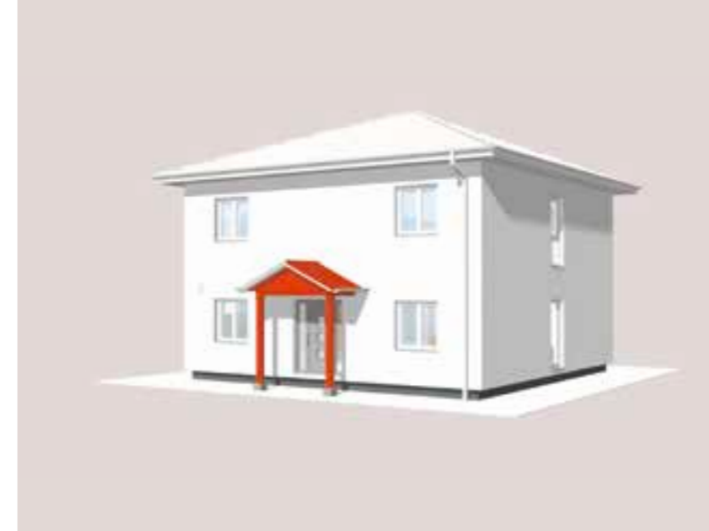
Abb.: Eingangsdach mit Giebel und verzinkten Stahlstützen
