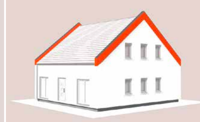
Abb.: Haus mit erhöhter Giebelwand
