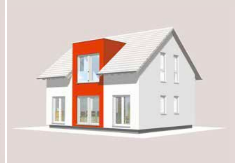
Abb.: Fassadengleiches Zwerchhaus mit Flachdach
