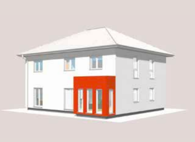
Abb.: Rechteckerker mit nicht begehbarem Flachdach
