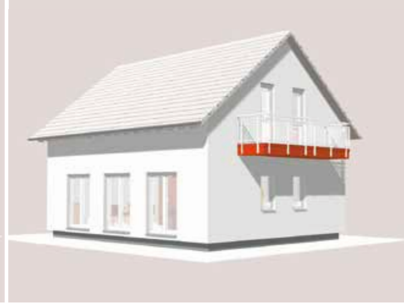
Abb.: Freitragender Balkon
