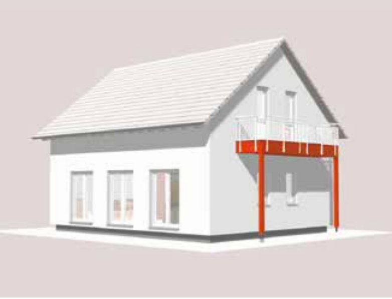
Abb.: Balkon auf Holzstützen
