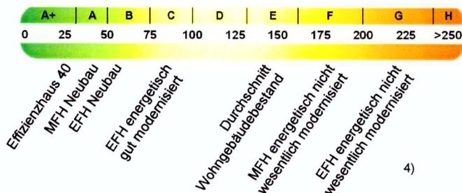
Die modellhaft ermittelten Vergleichswerte beziehen sich auf Gebäude, in denen die Wärme für Heizung und Warmwasser durch Heizkessel im Gebäude bereitgestellt wird. Soll ein Energieverbrauchskennwert eines mit Fern- oder Nahwärme beheizten Gebäudes verglichen werden, ist zu beachten, dass hier normalerweise ein um 15 - 30 % geringerer Energieverbrauch als bei vergleichbaren Gebäuden mit Kesselheizung zu erwarten ist.
