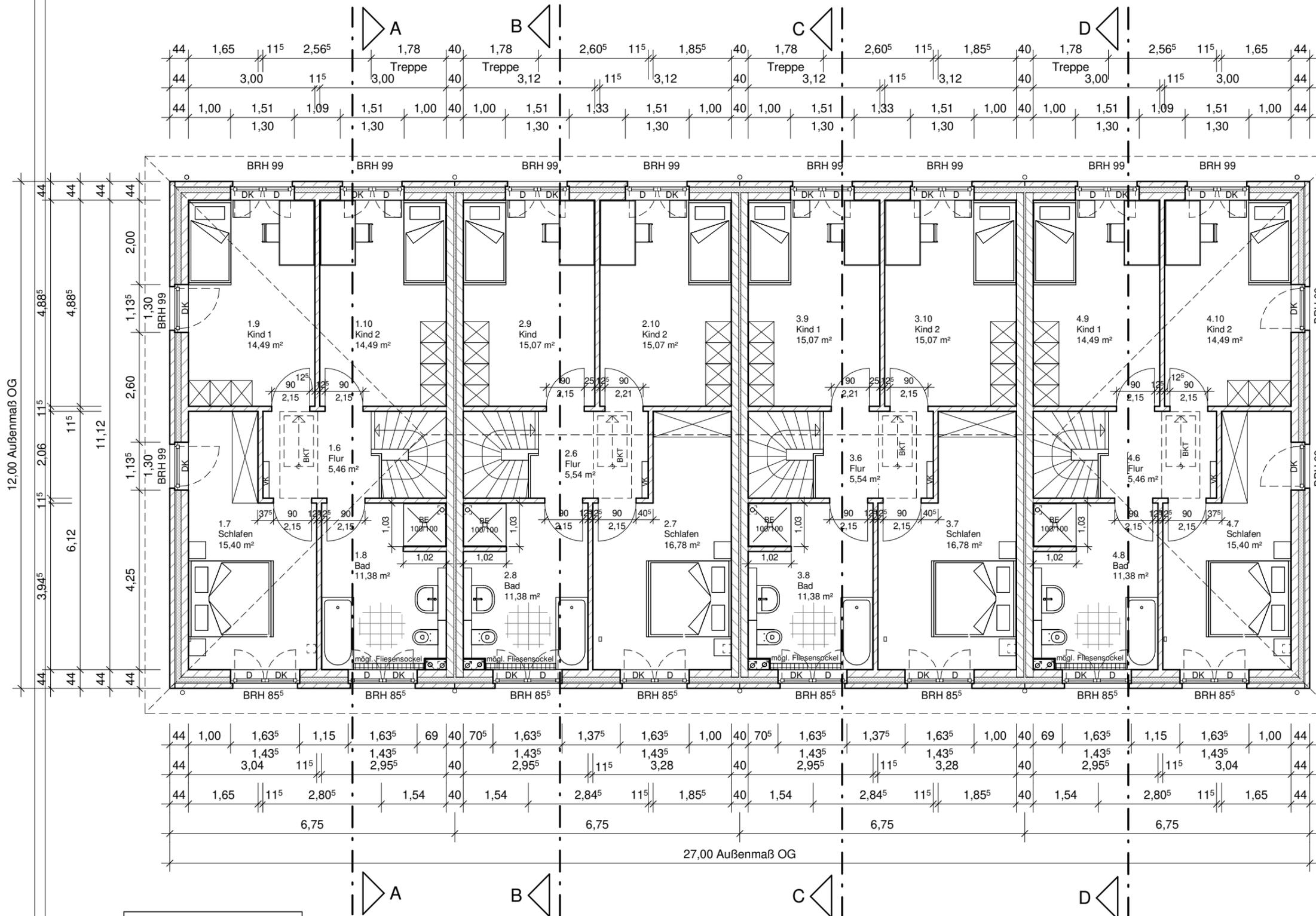
Die Höhe der nicht tragenden Innenwände bis 4.5 cm unter der Oberkante U-Schale der Außenwände hochmauern!
