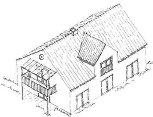
Satteldach 38° - 48°, E+D, Zwerchgiebel, Balkon aus Holz oder Stahl mit Glas- bzw. Blechüberdachung. Einheitliche Fensterformate mit französischen Balkonen im OG aus Holz oder Stahl. Kamin firstmittig positioniert.
